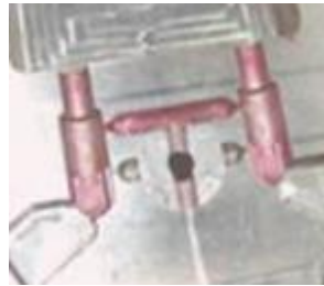
[그림 2] 안료 Migration에 의한 Mold Deposit
